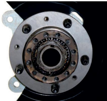
6. Установите тормозной диск на ступицу, не фиксируя его винтами М8х20
