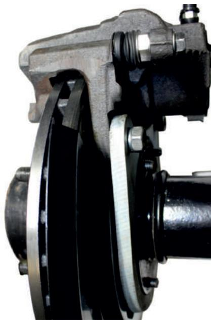
8. Соедините один конец тормозного шланга со скобой тормоза при помощи болта-штуцера и медных шайб. Установите кронштейн шланга под гайку стремянки рессоры. Второй конец шланга закрепите на кронштейне гайкой и шайбой. Соедините шланг со штуцером трубки (если резьба штуцера трубки M12, используйте переходной штуцер из комплекта).
