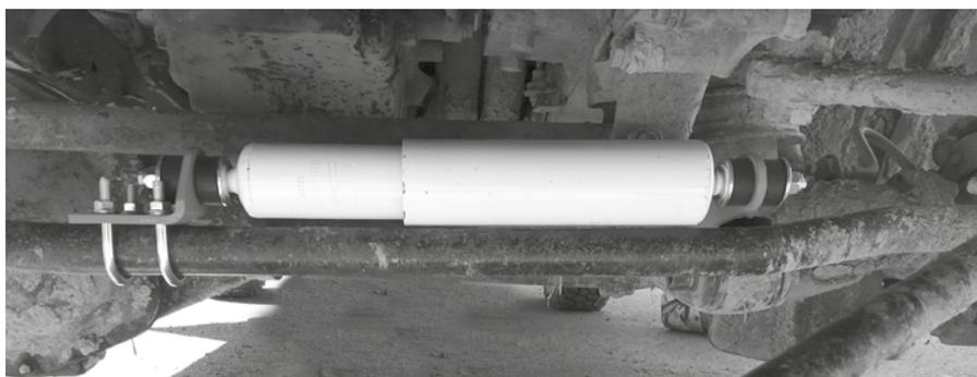
**Рулевой демпфер работает исправно и долго, если обеспечены малые углы расхождения геометрии между осью демпфера и осью рулевой тяги, на которую он устанавливается. Малые углы перелома уменьшают нагрузку на сайлентблоки демпфера, повышают эффективность демпфирования.**
